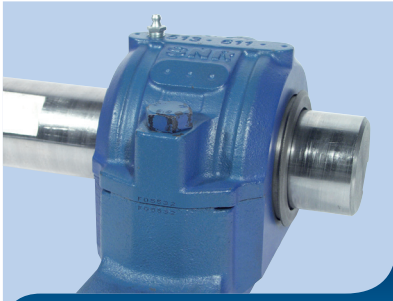
1 – ทำเครื่องหมายแสดงตำแหน่งของฝารองกันลื่นและแผ่นฐานให้ชัดเจนก่อนจะดึงจากกัน
