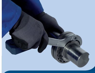
6 – เมื่อขันคลายนัท นัทจะหลุดออกต่อด้วยแหวนรองแบบล๊อค ตลับลูกปืนและปลอก
