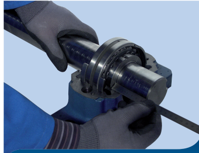
3 - ทำความสะอาดเพลลาเพื่อทำเครื่องหมายแสดงตำแหน่งของปลอก (จดขนาดการวัด)
