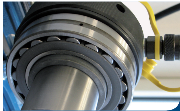
การถอดตลับลูกปืนด้วย Hydraulic Nut บนปลอกสวมเพลลา (ที่ติดตั้งในแบบตรงข้ามกับปลอกปรับขนาด)
