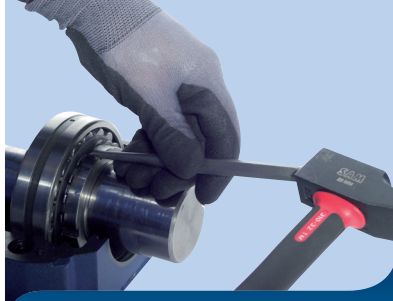
5 – หลังจากทำเครื่องหมายแสดงตำแหน่งแล้ว ดึงเช็ยวงแหวนล๊อคออกจากรูล๊อคนัท
